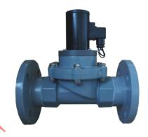
注:1、为保证电磁阀正常工作,电磁阀前须安装60~80目过滤器 2、电磁阀单向流通,如有背压,阀后须安装止回阀 3、电磁阀接电,可不分正负极
